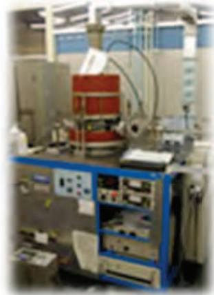
電子サイクロトロン共鳴 (ECR) エッチャー 30 nm加工実績
