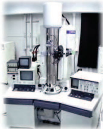
透過電子顕微鏡 加速電圧200kV 格子分解能0.1nm 電界放出型
