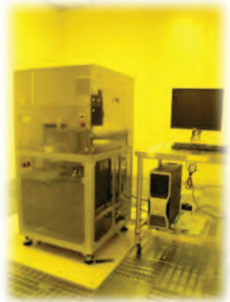
マスクレス露光装置 DL-1000 最小画素1μm フォトマスク不要 厚膜レジストの露光可能
