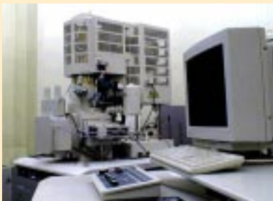
極微細パターンの形状・寸法を評価する電界放出型走査電子顕微鏡
