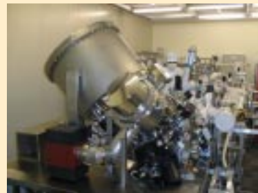
Si 表面の極薄膜の構造・組成を評価するための X 線光電子分光装置
