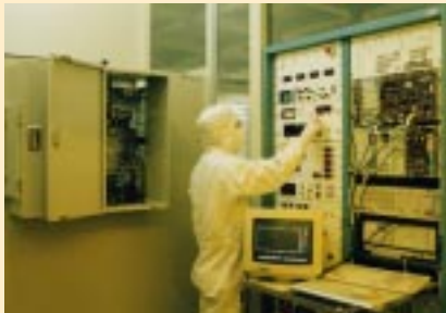
深さ 20nm 以下の極浅接合を形成するためのイオン注入装置
