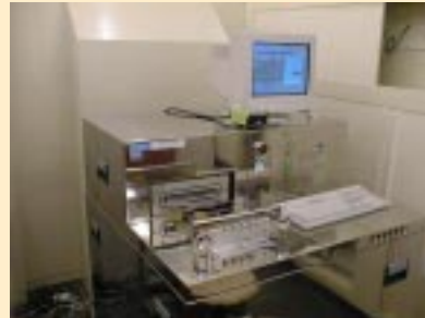
極浅接合中のドーパントを活性化するための高速熱処理装置
