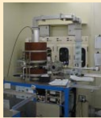
レジストパターンをポリシリコンに転写する ECR エッチング装置
